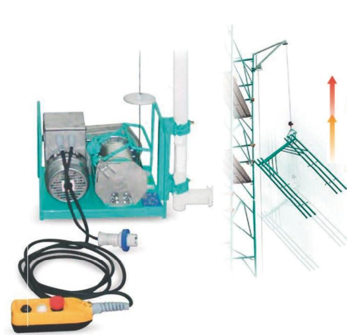
Ideal para el montaje rápido del adamiaje, gracias a la rápida colocación de la bandera giratoria y a su alta velocidad operativa (30 m/mto.). Carga máx. 150 kg de peso, para una altura de trabajo de 40 m. Motor eléctrico monofásico. Máxima seguridad, microrruptor de subida por tope y sistema antialarga-miento del cable.
